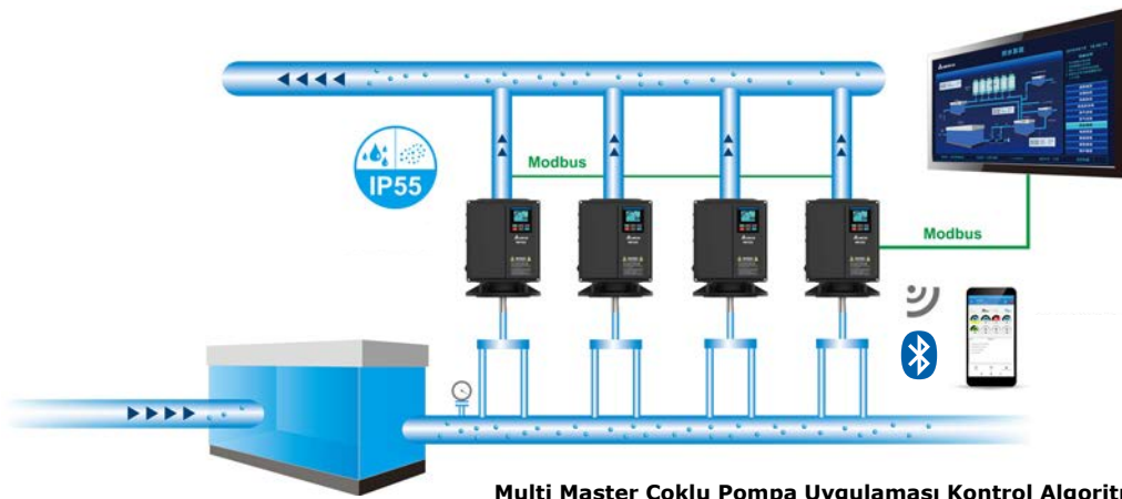
Multi Master Çoklu Pompa Uygulaması Kontrol Algoritması
